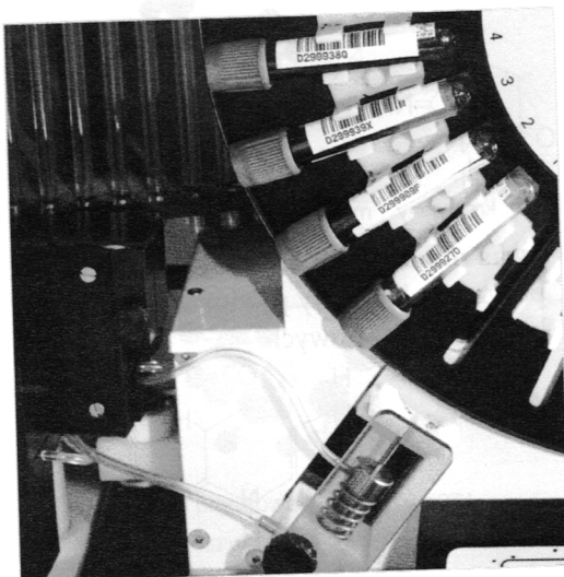
Ryc. 2.28. Probówki umieszczone w wirówce sedymencyjnej po przeciwnych stronach wirnika muszą mieć jednakową masę.
